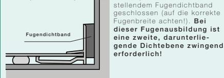
Die vorhandene Fuge wird mit vorkomprimiertem selbstrückstellendem Fugendichtband geschlossen (auf die korrekte Fugenbreite achten!). **Bei dieser Fugenausbildung ist eine zweite, darunterliegende Dichtebene zwingend erforderlich!**
